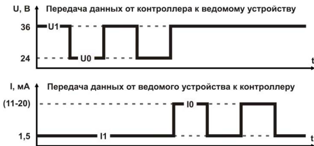
Рисунок 1 – Представление битов данных в интерфейсе M-Bus
