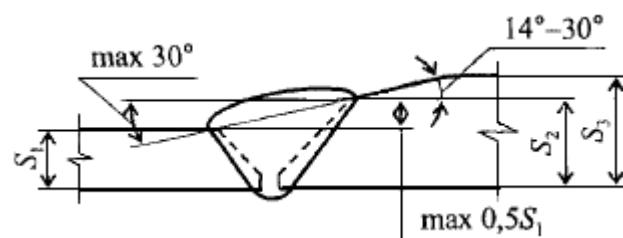
В Обработка стенки с толщиной  $S_3$  с наружной стороны до размера  $S_2 \leq 1,5S_1$
