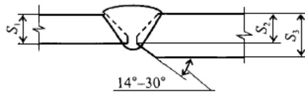
А Обработка стенки с толщиной  $S_3$  с внутренней стороны до размера  $S_2 = S_1$
