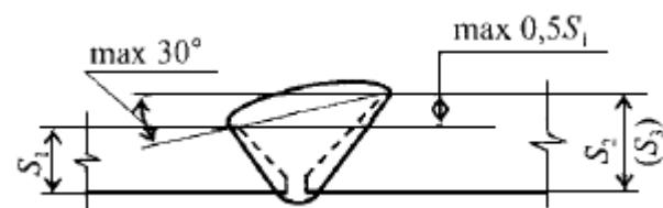
Б Соединение  $S_2(S_3)/S_1 \leq 1,5$  без дополнительной обработки свариваемых торцов ( $S_2 = S_3$ )
