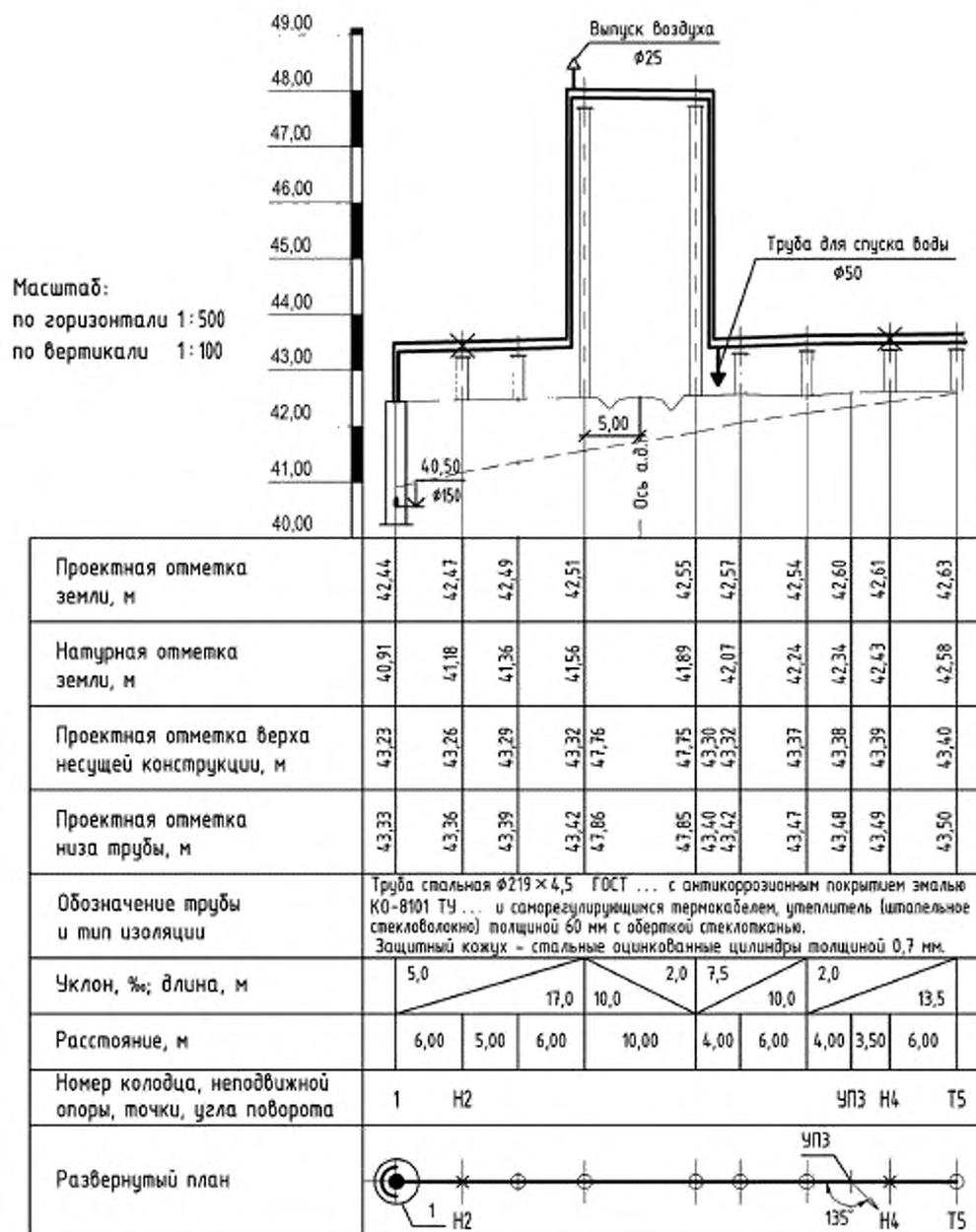
Рисунок В.3 — Пример выполнения профиля напорной сети при подземной прокладке
