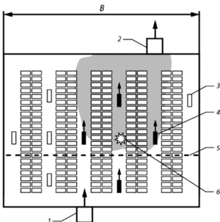
1 - система приточной противодымной вентиляции; 2 - система вытяжной противодымной вентиляции; 3 - выключенный струйный вентилятор; 4 - включенный струйный вентилятор; 5 - граница бездымной зоны; 6 - очаг пожара
