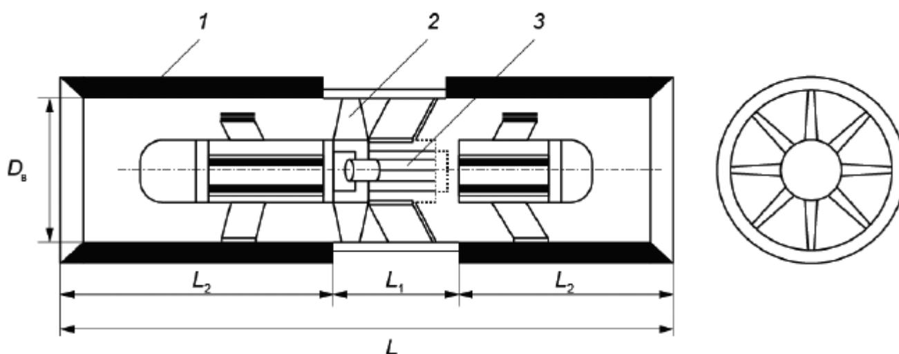
$L$  - общая длина струйного вентилятора;  $L_1$  - длина осевого реверсивного вентилятора с двигателем;  $L_2$  - длина глушителя; 1 - шумоглушитель; 2 - лопасти; 3 - двигатель
