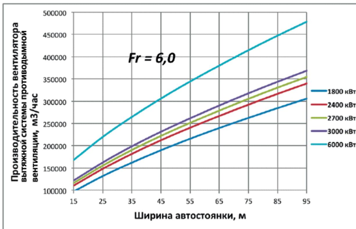
Рисунок Е.3\* - График зависимости производительности вентиляторов вытяжной системы противодымной вентиляции  $V_{ex}$  от ширины автостоянки  $B$  при различных значениях конвективной мощности пожара  $Q_k$ , при числе Фруда  $Fr = 6,0$
