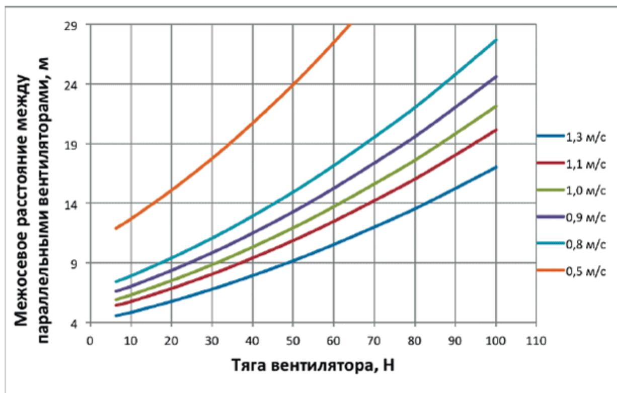
Рисунок И.2 - График зависимости межосевого расстояния  $b$  от расчетной реактивной тяги вентилятора  $F_p$  при различных значениях  $v_{x\text{min}}$
