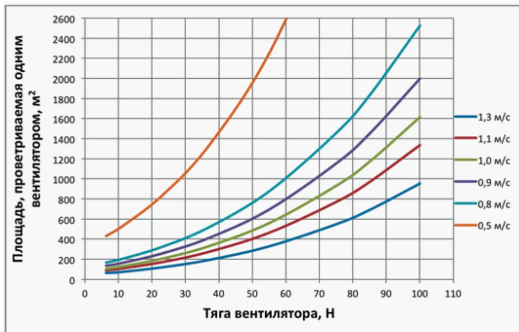
Рисунок И.3 - График зависимости площади  $S_{в1}$ , проветриваемой одним вентилятором, от расчетной реактивной тяги вентилятора  $F_p$  при различных значениях  $v_{x \min}$  [в соответствии с формулой (8.5)]
