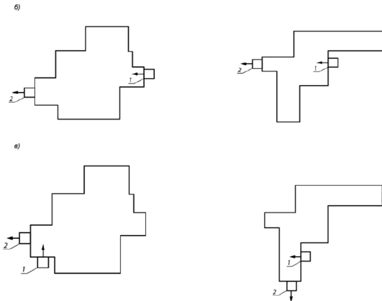
1 - приточный клапан; 2 - вытяжной клапан
