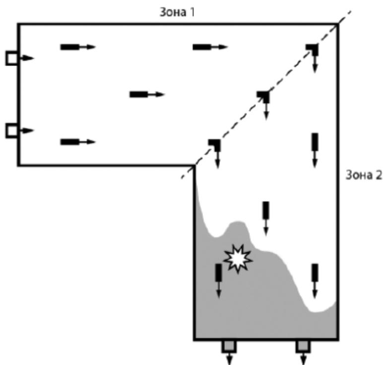
Рисунок Б.2 - Схема автостоянки, оснащенной системой струйной вентиляции на базе центробежных струйных
