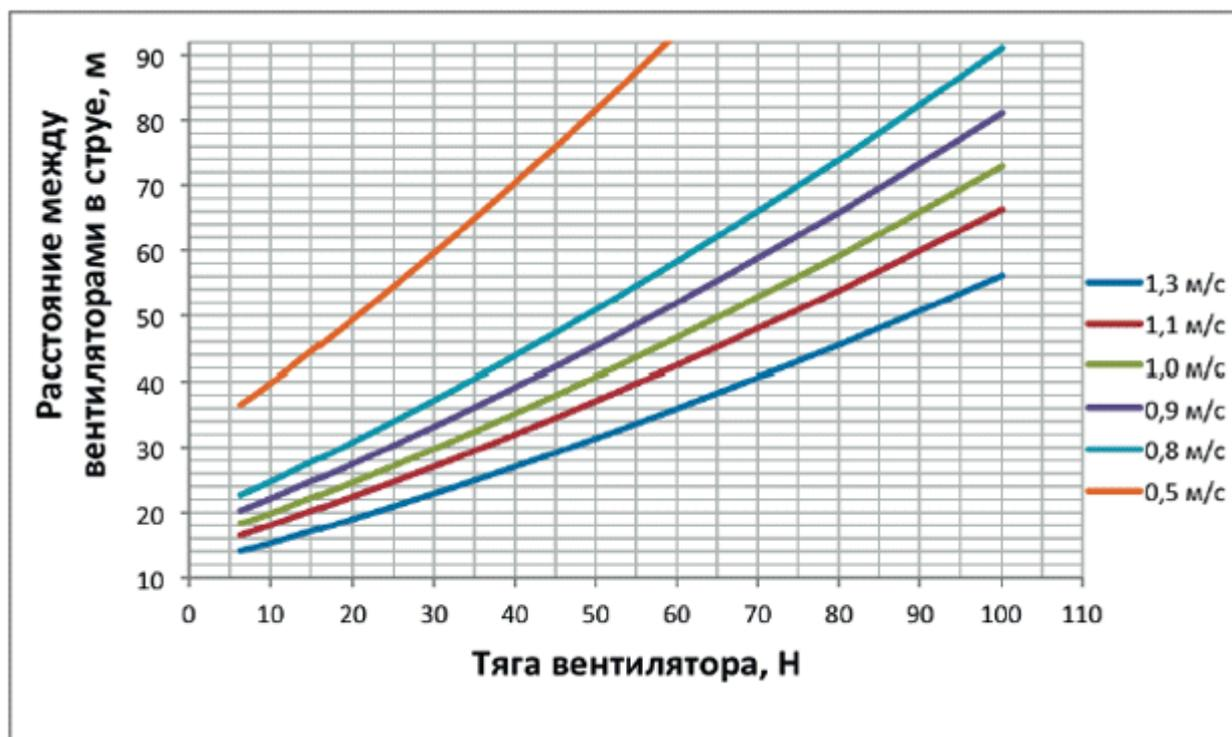
Рисунок И.1 - График зависимости расстояния  $L_{\text{ст}}$  (в струе) от расчетной реактивной тяги  $F_p$  вентилятора при различных значениях  $v_{x\text{min}}$
