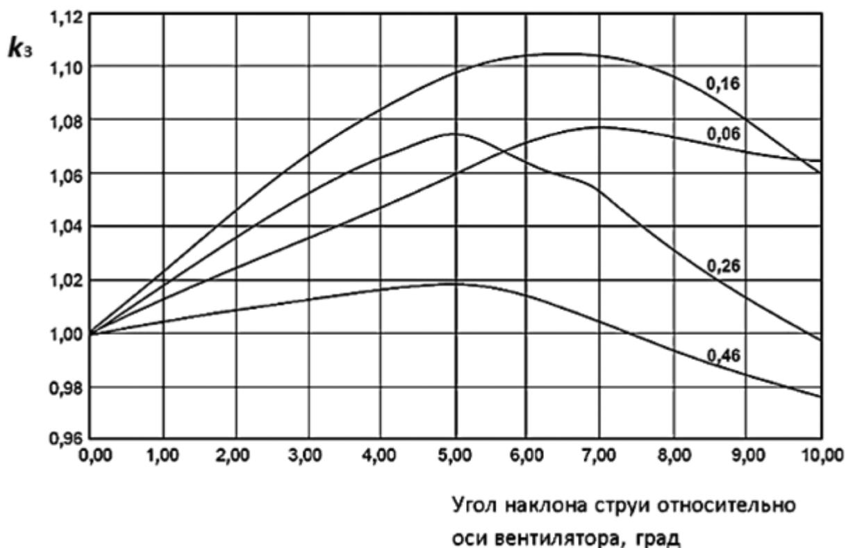
Рисунок 8.2 - График зависимости коэффициента  $k_z$  от угла наклона струи относительно оси струйного вентилятора
