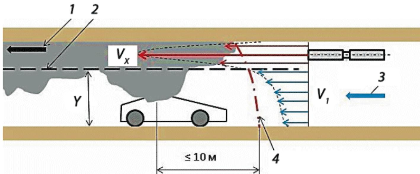
1 - вытяжка; 2 - условная граница раздела разноплотностных потоков воздуха; 3 - приток; 4 - расчетная граница дыма
