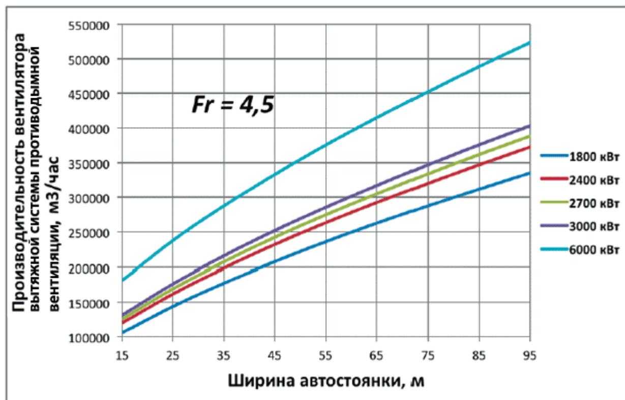
Рисунок Е.4\* - График зависимости производительности вентиляторов вытяжной системы противодымной вентиляции  $V_{ex}$  от ширины автостоянки  $B$  при различных значениях конвективной мощности пожара  $Q_K$ , при числе Фруда  $Fr = 4,5$
