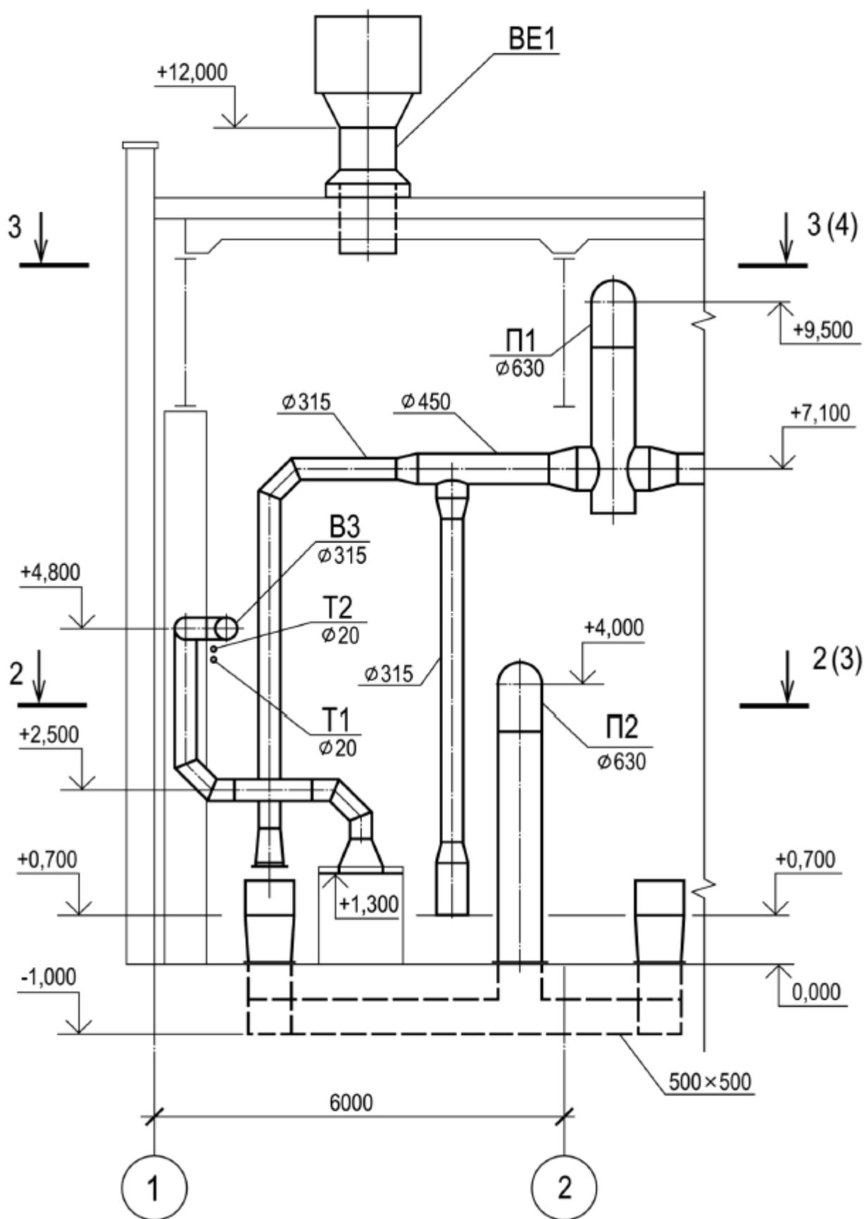
Рисунок Б.3 - Пример выполнения разреза систем
