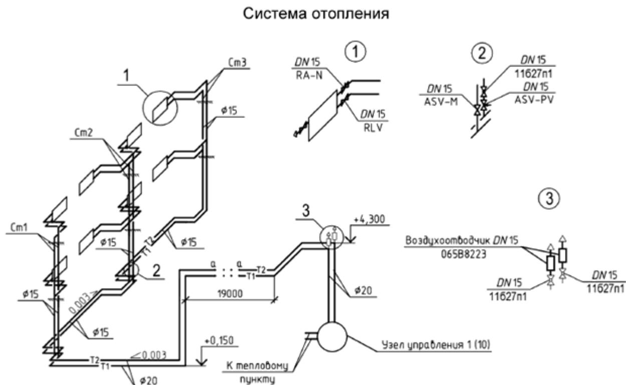
Рисунок В.1 - Пример выполнения схемы системы отопления
