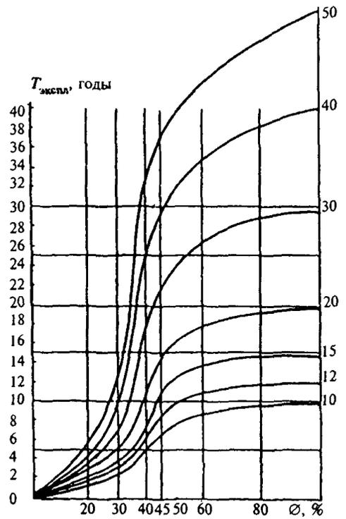
**Рис. 3. Физический износ системы внутреннего горячего водоснабжения**
