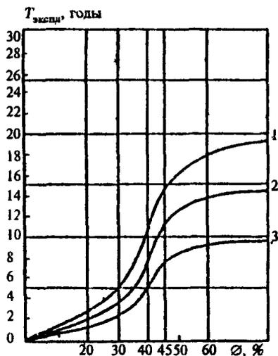
**Рис. 4. Физический износ системы центрального отопления**
