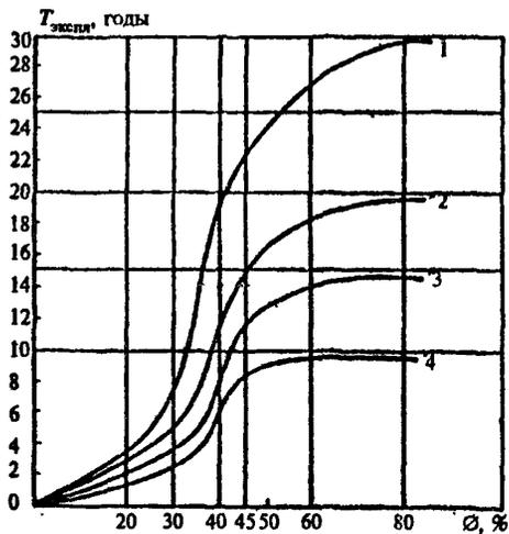
Рис. 5. Физический износ системы внутреннего водопровода
